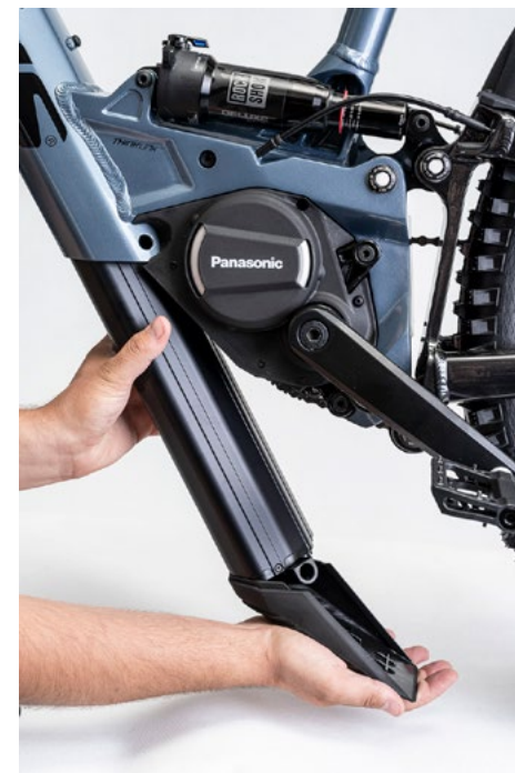
OBRÁZEK 3: SPRÁVNÉ DRŽENÍ BATERIE BĚHEM VYJMUTÍ
