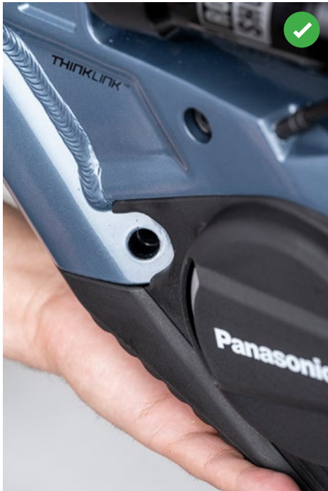
ABBILDUNG 7: ÜBERPRÜFUNG DER ÜBERLAPPUNG DER MOTORABDECKUNG MIT DER AKKUABDECKUNG AUF DER LINKEN SEITE (NICHTRANTRIEBSSEITE)
