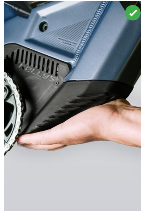
ABBILDUNG 8: ÜBERPRÜFUNG DER ÜBERLAPPUNG DER MOTORABDECKUNG MIT DER AKKUABDECKUNG AUF DER RECHTEN SEITE (ANTRIEBSSEITE)
