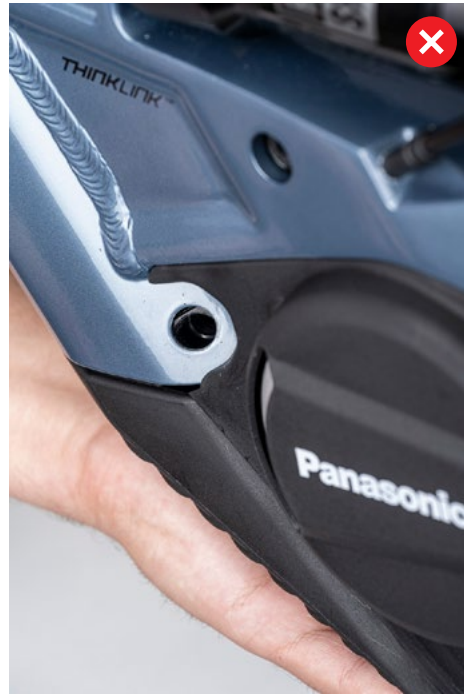
ABBILDUNG 7: ÜBERPRÜFUNG DER ÜBERLAPPUNG DER MOTORABDECKUNG MIT DER AKKUABDECKUNG AUF DER LINKEN SEITE (NICHTRANTRIEBSSEITE)
