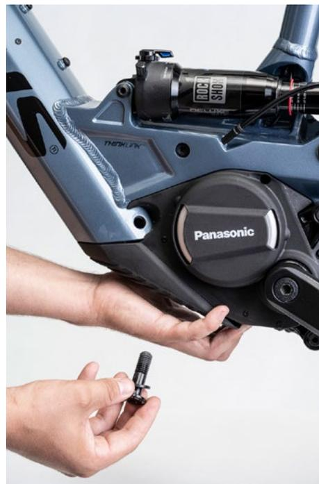
**FIGURE 2:** EXTRACTION DE LA VIS
