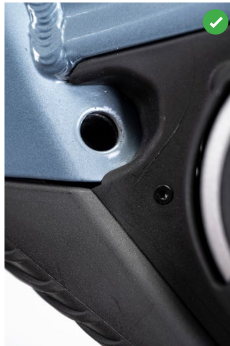
6. ÁBRA: A VÁZBAN ÉS AZ AKKUMULÁTORBAN LEVŐ LYUK ILLESZKEDÉSÉNEK AZ ELLENŐRZÉSE
