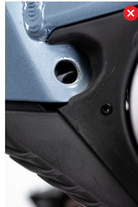
6. ÁBRA: A VÁZBAN ÉS AZ AKKUMULÁTORBAN LEVŐ LYUK ILLESZKEDÉSÉNEK AZ ELLENŐRZÉSE
