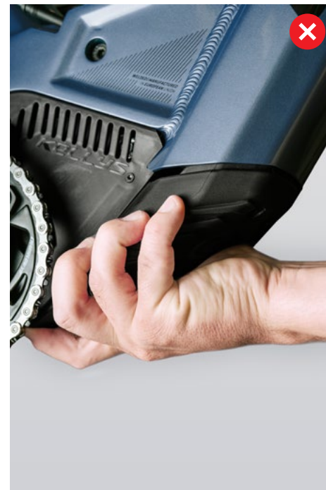
8. ÁBRA: A MOTORBURKOLAT ÉS AZ AKKUMULÁTORBURKOLAT JOBBOLDALI (MEGHAJTÁS-OLDAL) ILLESZKEDÉSÉNEK AZ ELLENŐRZÉSE
