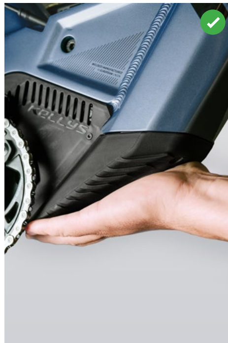
8. ÁBRA: A MOTORBURKOLAT ÉS AZ AKKUMULÁTORBURKOLAT JOBBOLDALI (MEGHAJTÁS-OLDAL) ILLESZKEDÉSÉNEK AZ ELLENŐRZÉSE
