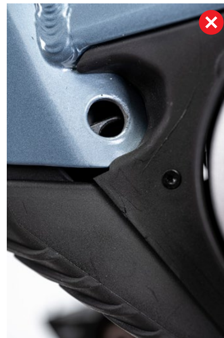
OBRÁZOK 6: OVERENIE SÚSTREDNOSTI DIERY V RÁME A BATÉRIÍ
