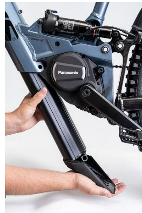
OBRÁZOK 3: SPRÁVNE DRŽANIE BATÉRIE POČAS VYŤIAHOVANIA
