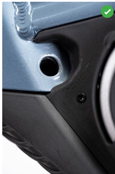
OBRÁZOK 6: OVERENIE SÚSTREDNOSTI DIERY V RÁME A BATÉRIÍ
