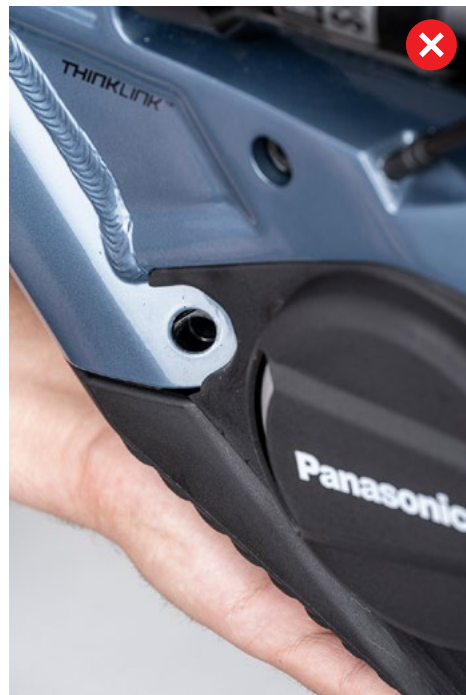
OBRÁZOK 7: OVERENIE PREKRYTIA KRYTU MOTORA KRYTOM BATÉRIE NA ĽAVEJ STRANE (STRANA BRÝD)
