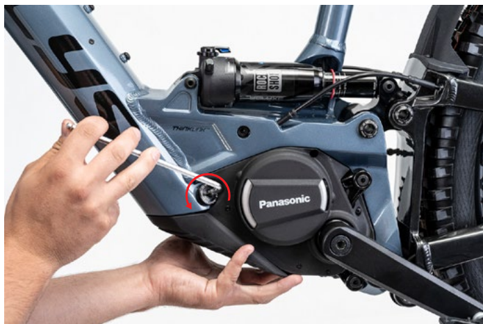
OBRÁZOK 1: UMIESTNENIE SKRUTKY A SMER OTÁČANIA
