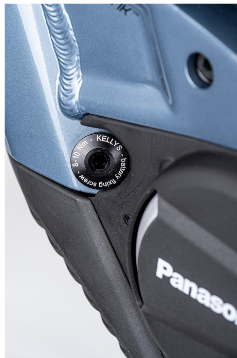
OBRÁZOK 10: HLAVA SKRUTKY S PREDPÍSANÝM MOMENTOM
